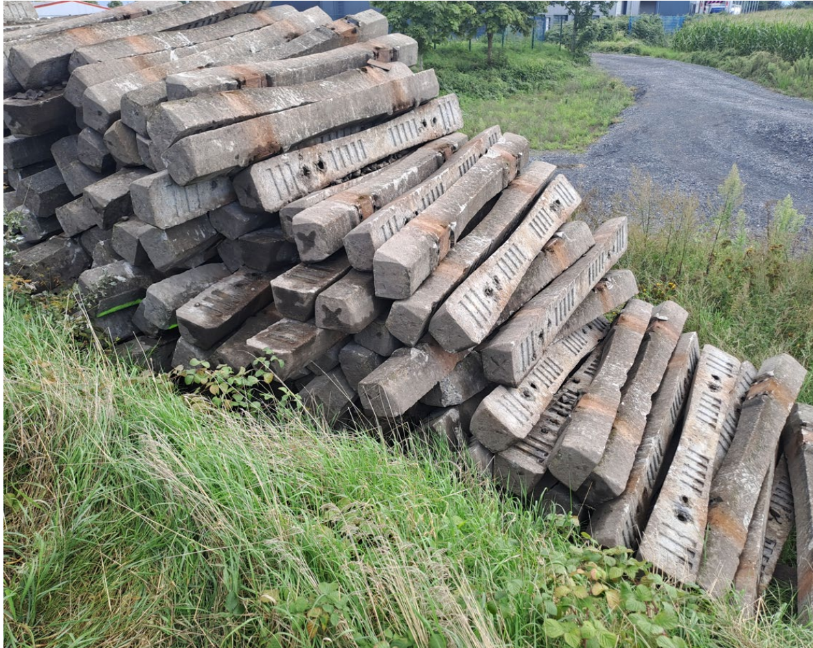
Ausgebaute alte Schwellen ohne Besohlung
