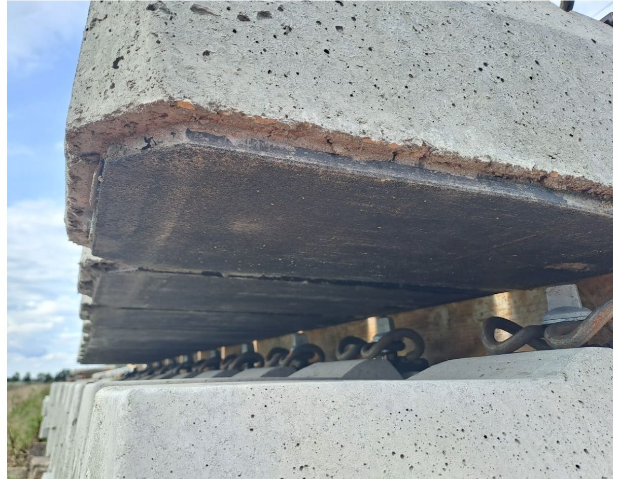
Neue besohlte Schwelle zum aktiven Erschütterungsschutz
